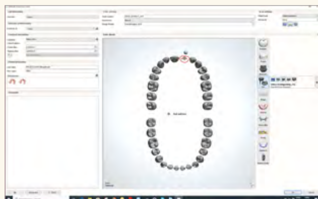
40 · Após o escaneamento inicia-se a sequência de desenho do pino digital. Aqui temos a pagina inicial do Software Dental Systems definindo o trabalho a ser executado. Neste caso faremos um pino digital.
