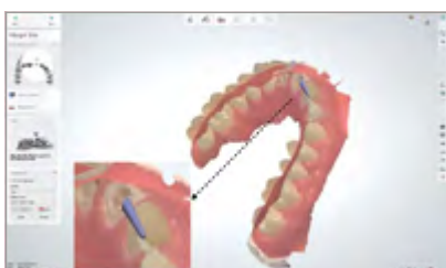
45 • Esta imagem mostra a perspectiva do alinhamento do scanbody virtual com o scanbody escaneado visto internamente. Note em azul o scanbody virtual correspondendo ao formato que obteremos após a manufatura do pino.
