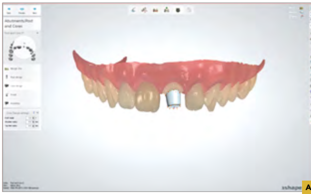
48A,B - Depois do alinhamento dos componentes digitais, delimitação da margem do pino e checagem do alinhamento, no próximo passo o software faz uma proposta inicial da forma do pino. Observe em uma perspectiva frontal e lingual.
