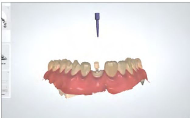
42 • Alinhamento digital do scanbody escaneado com seu respectivo análogo virtual (em azul escuro).
