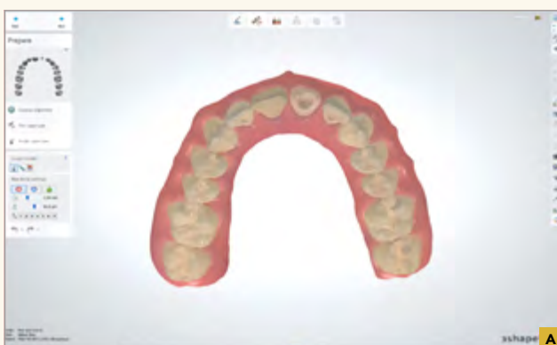
41A,B · O escaneamento obtido é aberto do software dental systems para iniciarmos o desenho. Aqui vemos uma vista oclusal e frontal. Note que o scanbody não está presente. A razão está no que foi mencionado anteriormente na Figura 15 sobre o escaneamento prévio antes do posicionamento do scanbody no conduto. Nesta etapa aqui podemos fazer mudanças e modificações no modelo virtual antes que ocorra o alinhamento do scanbody escaneado com seu homólogo digital presente no software .
